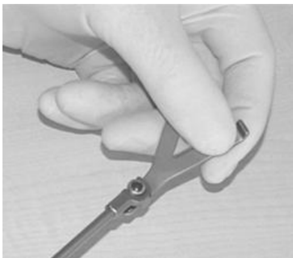
Fig. 10: Os garfos auriculares são introduzidos axialmente no encaixe distal da guia de gancho até ao batente lateral.
