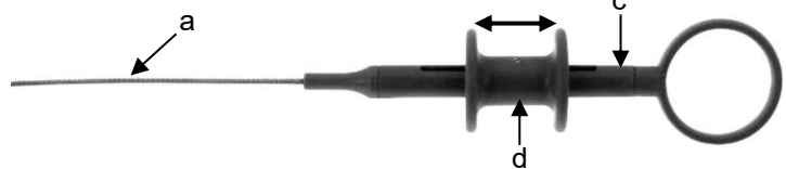
Fig. 1b: Poignée de rouleau de traction du bioptome du myocarde, extrémité proximale
