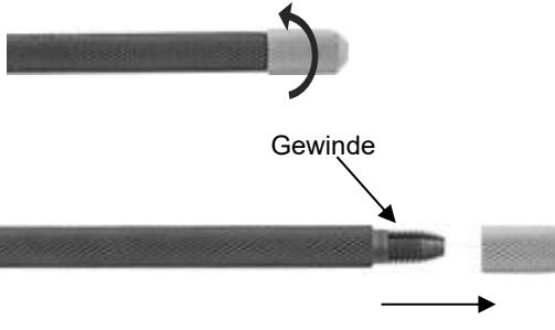
2. Das in seine Einzelteile zerlegte Instrument kann nun aufbereitet werden.
