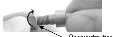
4. Der in seine Einzelteile zerlegte LL-Anschluss kann nun aufbereitet werden.
