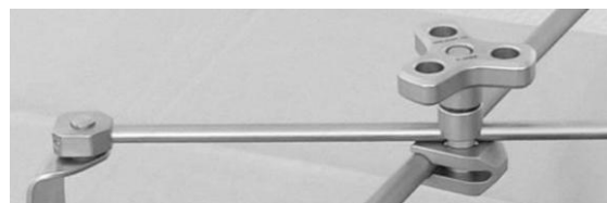
Abb. 15: Hakenführung am proximalen Ende mit dem Kreuzverbinder befestigt und am distalen Ende befindet sich die Blattaufnahme
