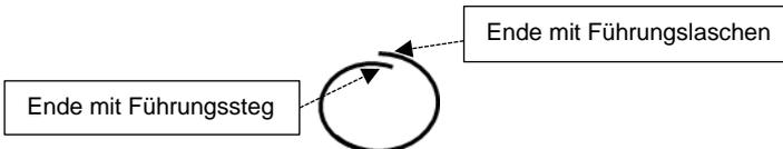
2. Die Führungslaschen (1) über die Einführöffnung (2) bringen und die Führungslaschen (1) einbringen. Danach den Druck etwas lösen und die Führungslaschen (1) den Führungssteg (3) entlang gleiten lassen.
