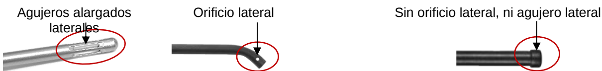
Fig. 2: Aspirador con falso orificio de ventilación (ejemplo)
