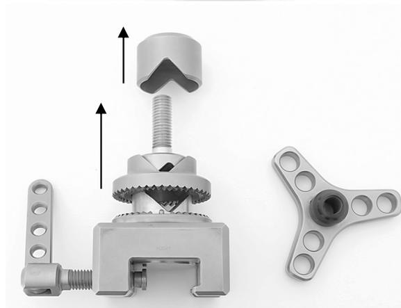
3. A questo punto è possibile trattare lo strumento smontato nei singoli componenti.
