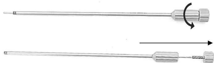
2. A questo punto è possibile trattare lo strumento smontato nei singoli componenti.
