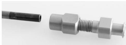
3. Der LL-Anschluss (3) besteht aus zwei Teilen, einem geschlitzten Aufnahmegebinde sowie einer Überwurfmutter. Zum Trennen der beiden Teile die Mutter gegen den Uhrzeigersinn drehen, bis diese sich abnehmen lässt.
