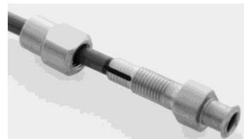
3. Die Überwurfmutter auf das geschlitzte Aufnahmegewinde schieben und mit Hilfe zweier Maulschlüssel (4) im Uhrzeigersinn bis zum Anschlag drehen.
