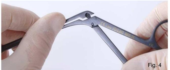
Figure 4 : faire glisser le coulisseau vers le haut et le reposer légèrement sur l'ergot de guidage de la branche mobile.
