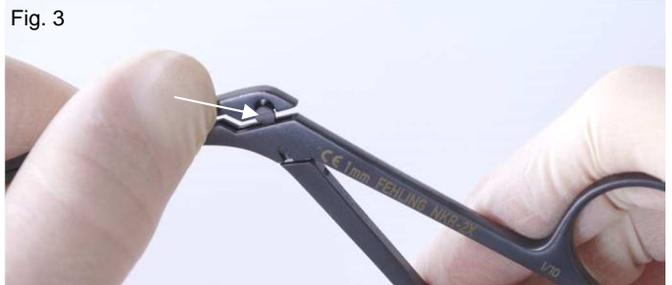
Figure 3 : repousser le coulisseau vers l'arrière jusqu'à ce que l'ergot de guidage de la branche mobile (voir la flèche blanche dans la figure) se détache de son logement dans le coulisseau.
