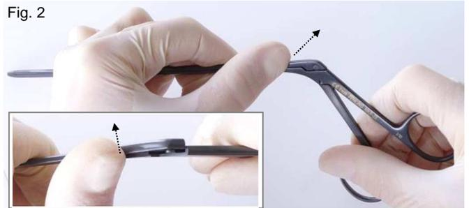
Prendre dans les deux mains le rongeur fermé (la mâchoire est fermée) comme illustré dans la Figure 2 et écarter doucement le coulisseau hors de l'axe de guidage avec le pouce de la main gauche.
