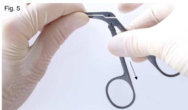
Figure 6 : tirer le coulisseau jusqu'en butée en direction de la branche fixe jusqu'à ce que la mâchoire soit entièrement ouverte. Les tourillons de liaison du coulisseau sont alors retirés de leurs logements dans la tige et le coulisseau se déplace ainsi librement sur son axe.
