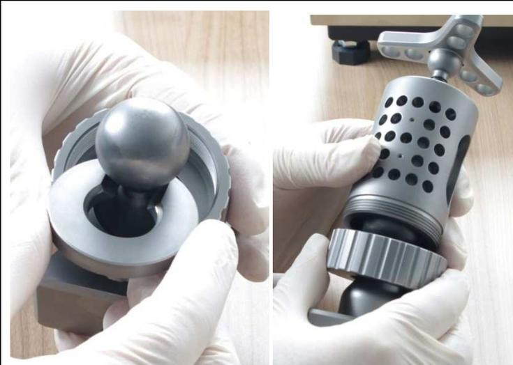
Emboîter l'écrou-chapeau sur l'articulation sphérique, puis la rondelle et son encoche sur le col de l'articulation sphérique afin qu'elle soit positionnée sur le fond interne de l'écrou-chapeau. Le discret chanfrein de la rondelle est orienté en direction de la sphère. Puis, visser le module à trois composants avec l'écrou-chapeau sur le cylindre de serrage.
