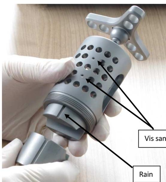
Commencer par emboîter la mâchoire de pince externe puis la mâchoire de pince interne dans le cylindre de serrage. Veiller à ce que les deux petites vis sans tête ressortant de la paroi interne du cylindre de serrage passent dans la rainure des mâchoires de pince. Elles servent de dispositif anti-rotation.
