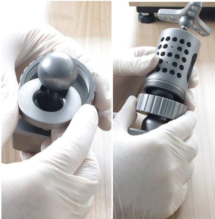
Die Überwurfmutter über die Kugel schieben, die Scheibe mit ihrer Aussparung um den Kugelhals schieben, sodass sie auf dem inneren Boden der Überwurfmutter zum Liegen kommt. Die kleine Fase der Scheibe zeigt Richtung Kugel. Danach die 3-teilige Baugruppe mit der Überwurfmutter auf den Spannzylinder schrauben.
